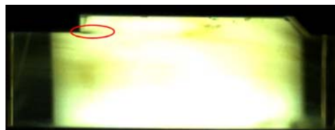
图 13 0.1 mm 孔径喷嘴喷注压力为 3.3 MPa 时煤油液雾直观分布
