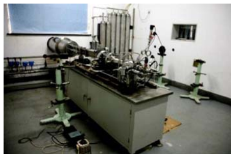
图 1 直连式试验台
